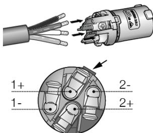
NL4 input/output wiring
